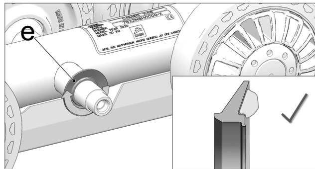
2.2 Appliquer uniformément 3 à 3.5 cc de graisse dans la rainure en V (e). Appliquer tout autour.
