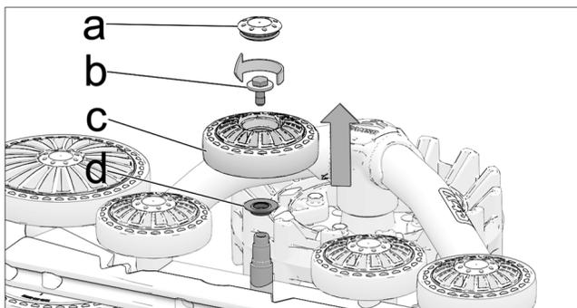
1.1 Retirer le capuchon (a), dévisser et retirer le boulon (b), retirer la roue (c) de l'arbre de roue, retirer le joint d'étanchéité (d).
