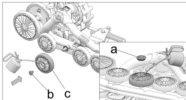
2.4 Insérer la nouvelle roue (c) sur l'arbre en faisant contact avec le joint. Installer le nouveau boulon (b) et serrer à **30 N·m** (22 lb-pi).
