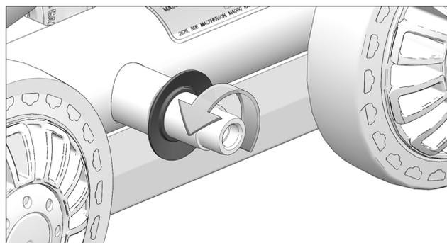
2.3 Appliquer uniformément de la graisse tout autour de l'arbre de roue avant d'installer la nouvelle roue.
