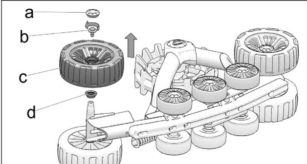
1.1 Retirer le capuchon (a), dévisser et retirer le boulon (b), retirer la roue (c) de l'arbre de roue, retirer joint d'étanchéité (d).
