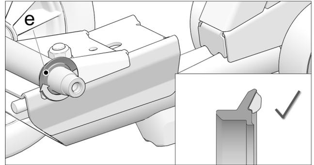
2.2 Appliquer uniformément 3 à 3.5 cc de graisse dans la rainure en V (e). Appliquer tout autour.
