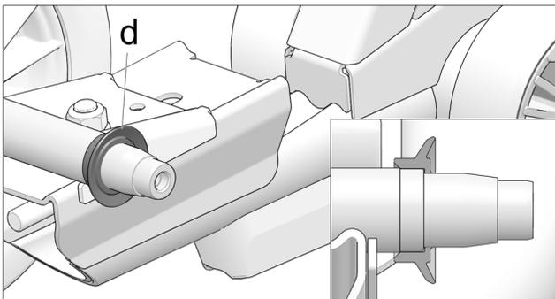
2.1 Installer, tel qu'illustré ci-dessus, le nouveau joint d'étanchéité (d) sur le diamètre de l'arbre de roue, asséché et nettoyé préalablement.
