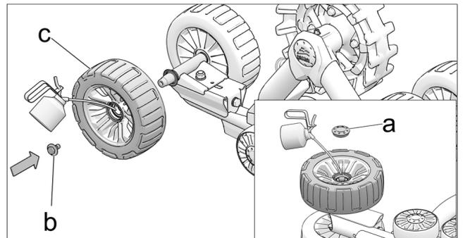
2.4 Insérer la nouvelle roue (c) sur l'arbre en faisant contact avec le joint. Installer le nouveau boulon (b) et serrer à **30 N-m** (22 lb-pi).
