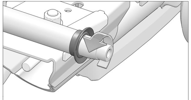
2.3 Appliquer uniformément de la graisse tout autour de l'arbre de roue avant d'installer la nouvelle roue.
