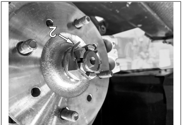
ATTENTION : Assurez-vous que la goupille fendue (2) de l'écrou de l'essieu n'interfère pas au moyen du système de traction. Voir la Fig. 9
