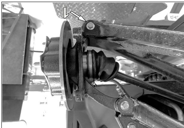
5. Retirer le boulon (1) qui fixe le bras de suspension intérieur au moyeu de roue. Voir la Fig. 5
